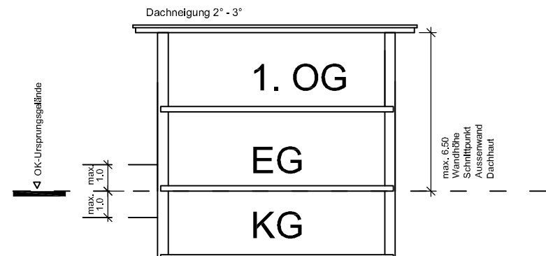
Regelschnitt Gebäude Typ IV (E+1.OG) Flachdach (2°-3°) M 1 : 200
